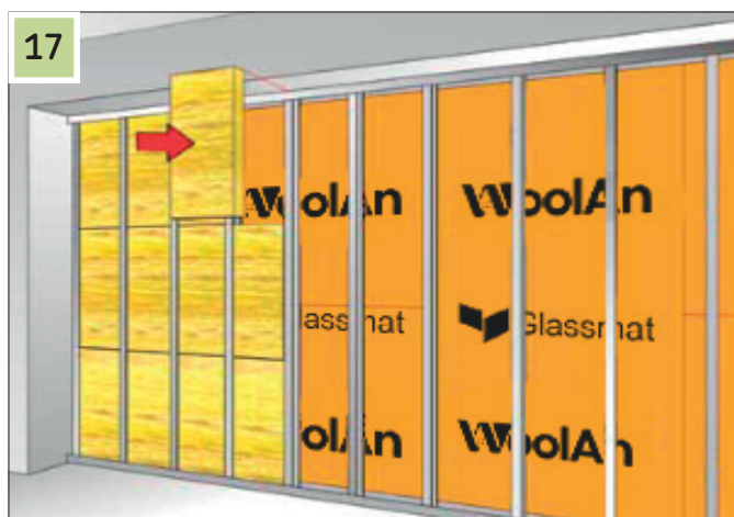
Укладка минеральной ваты осуществляется между профилями
