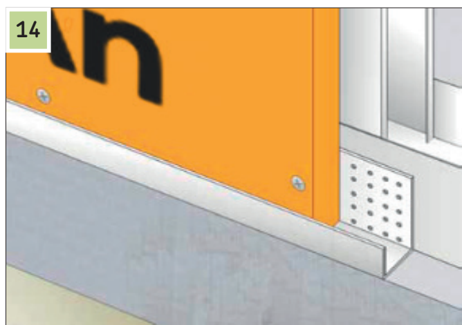
WGP пропускается через пластиковый стартовый профиль и крепится к опорному профилю
