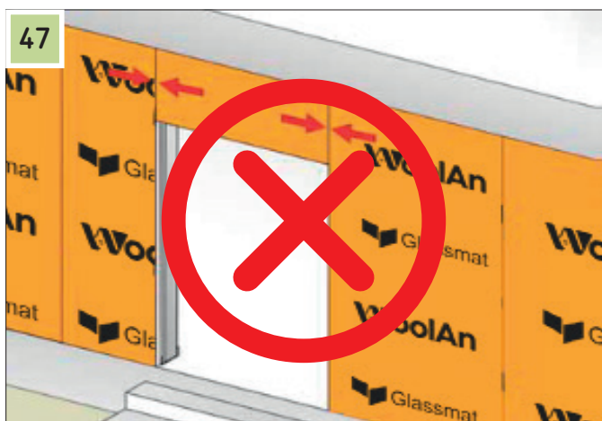
Неправильный монтаж. Швы WGP не должны стыковаться с краями проема
