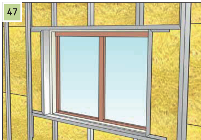
47 Укладка минеральной ваты. Чтобы обеспечить непрерывность изоляции в полости профилей, укладывают минеральную вату низкой плотности с небольшим поджатием.
