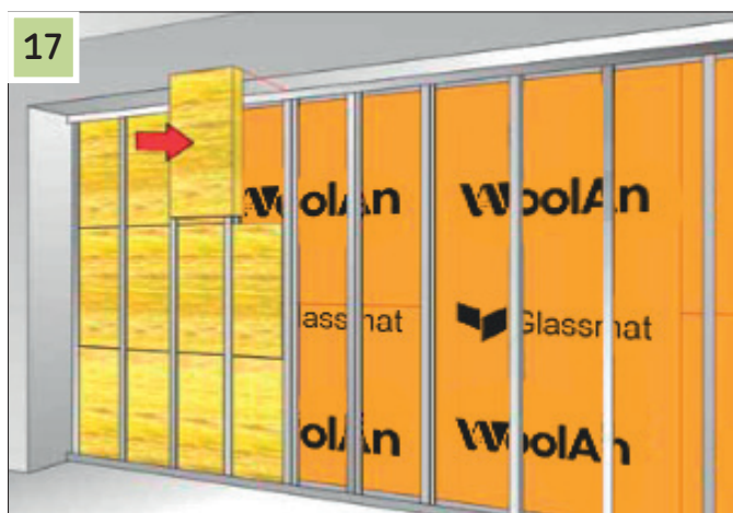
Укладка минеральной ваты осуществляется между профилями
